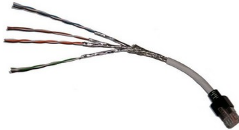
Abb. 3.2.: STP-Kabel im Schnitt
