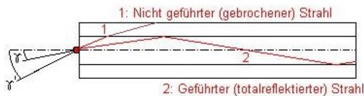
Abb. 3.4.: Funktionsweise eines Lichtwellenleiters [10]
